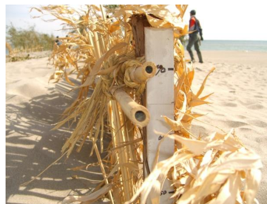
↑ 砂の堆積の目印 (1年後) (砂が1年で約50cm堆積した。)
