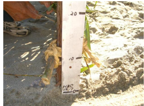
↑ 砂の堆積の目印 (砂の堆積を測るための目印。)
